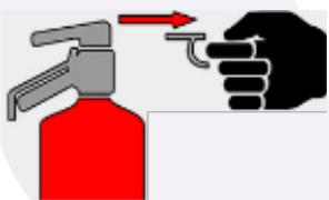
da alavanca e puxe-o com força para fora, rompendo o lacre, e faça um teste, de preferência no local onde se encontra o extintor, para confirmar seu funcionamento e o agente extintor.
